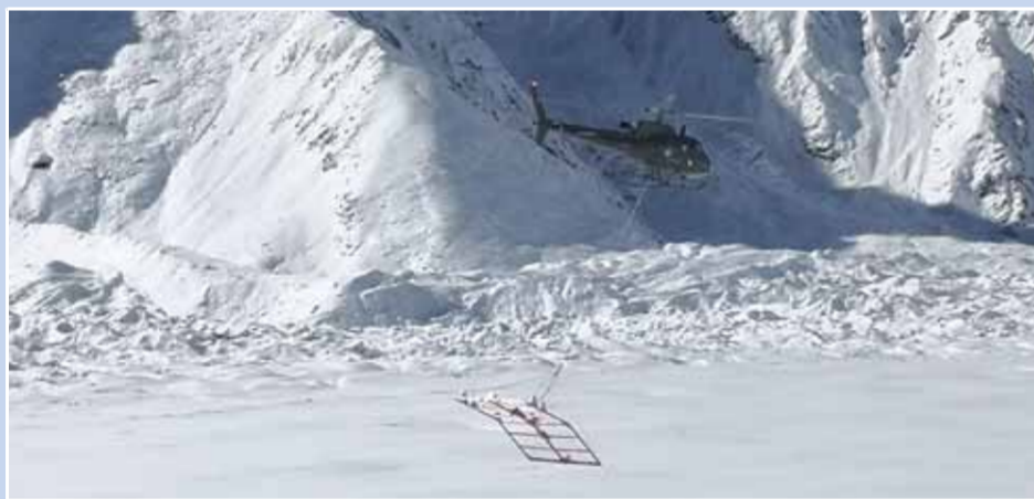
首次采用直升机载雷达给冰川测厚。
